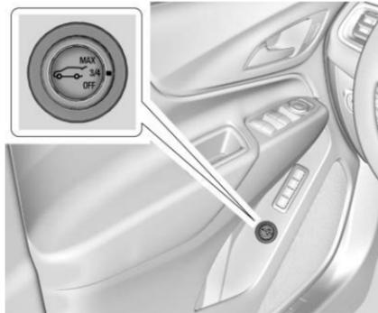
Para operar la puerta trasera eléctrica, el vehículo debe estar en P (estacionamiento). Las luces traseras parpadean cuando se mueve la puerta trasera eléctrica.
