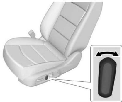
Para reclinar un respaldo con ajuste eléctrico, si está equipado con éste:
