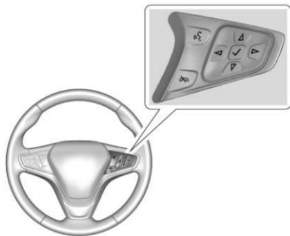
Presione ◀ o ▶ para seleccionar el menú VEHICLE (Vehículo), y después use ▲ o ▼ para desplazarse a través de los elementos del menú para seleccionar TCS/StabiliTrak/ESC.
