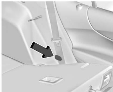
4. Guarde el cinturón de seguridad en el sujetador de almacenamiento del cinturón. Repita los pasos para doblar el otro respaldo, si lo desea.
