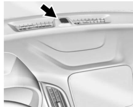
Hay un sensor de luz en la parte superior del tablero de instrumentos. NO cubra el sensor; de otra manera los faros se encenderán cuando no es necesario que lo hagan.
