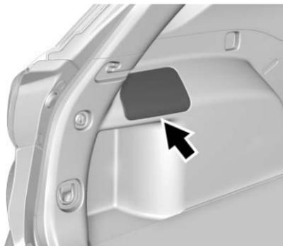
El bloque de fusibles del compartimiento trasero se encuentra detrás del tablero de moldura en el lado del compartimiento trasero.
