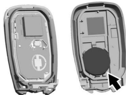
3. Retire la batería empujándola y deslizándola hacia la parte inferior del transmisor.
