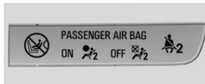
El sistema de sensor del pasajero apaga la bolsa de aire delantera exterior del pasajero bajo ciertas condiciones. Ninguna otra bolsa de aire es afectada por el sistema de detección de pasajeros. Vea *Sistema de detección de pasajeros* ⇨ 95.
