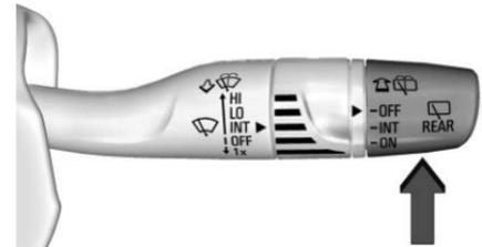
Gire el extremo de la palanca del limpiaparabrisas para operar el limpiaparabrisas/lavaparabrisas de la ventana trasera.
