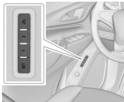
Si está equipado, los asientos de memoria permiten que dos conductores guarden y recuperen sus posiciones de asiento únicas para conducir el vehículo, y una posición de salida compartida para salir del vehículo. También se pueden guardar otras posiciones de función, tales como los espejos eléctricos y el volante de dirección hidráulica, si está equipado. Las posiciones de memoria están
