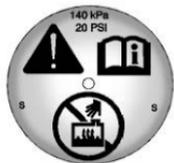
El tapón de presión del tanque de compensación del refrigerante puede quitarse cuando el sistema de enfriamiento, incluyendo el tapón de presión del tanque de compensación y la manguera superior del radiador, ya no estén calientes.
