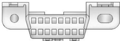
El DLC está debajo del tablero de instrumentos del lado izquierdo del volante. Conectar dispositivos que no se utilicen para realizar una Inspección de emisiones/Prueba de mantenimiento o para dar servicio al vehículo puede afectar la operación del vehículo. Vea *Equipo eléctrico añadido* ⇨ 307. Visite a su distribuidor si necesita asistencia.
