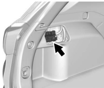
Retire la placa de moldura para tener acceso al bloque de fusibles.
