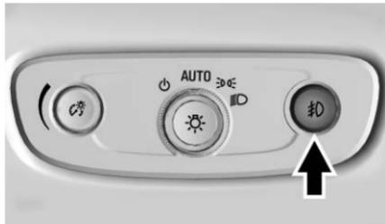
El botón de luces de niebla está en el tablero de instrumentos junto al volante de dirección.
