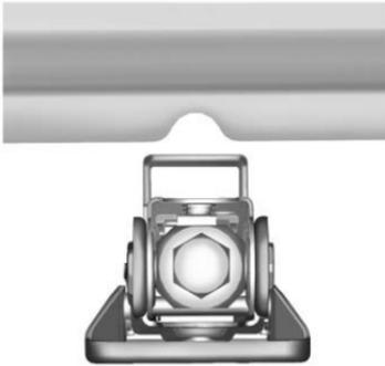
Ubique la muesca en el reborde de soldadura de lámina. Coloque el centro de la cabeza de elevación del gato en el centro de la muesca de la lámina.
