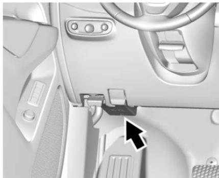
El bloque de fusibles del tablero de instrumentos está debajo del tablero de instrumentos en el lado del conductor.
