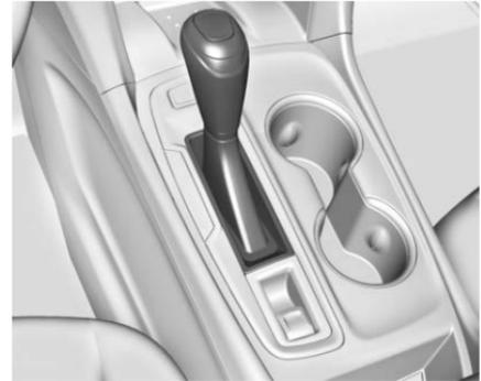
**P** : Esta posición bloquea las ruedas delanteras. Utilice P (estacionamiento) al arrancar el motor, ya que el vehículo no puede moverse con facilidad.
