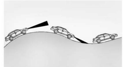
No utilice el ACC al conducir en colinas pronunciadas o al arrastrar un remolque, el ACC no detectará un vehículo en el carril al conducir en colinas pronunciadas. Si aplica los frenos, el ACC se desactiva.
