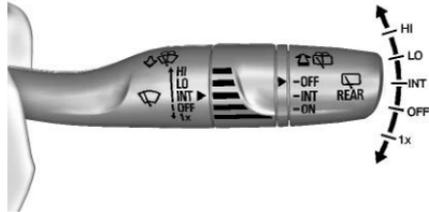
La palanca del limpiaparabrisas/lavador está en el costado de la columna de dirección. Con la
