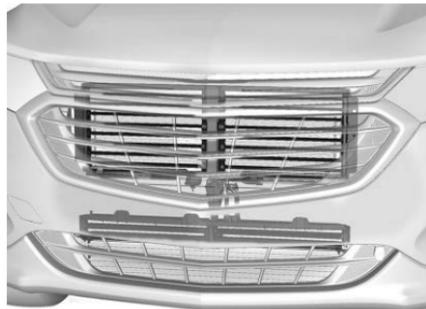
El vehículo puede contar con un sistema de obturador diseñado para ayudar a aumentar la economía de combustible. Mantenga limpio el sistema de obturador para un funcionamiento correcto.
