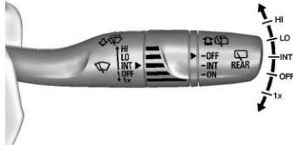
La palanca del limpiaparabrisas/lavador está en el costado de la columna de dirección. Con la ignición encendida o en ACC/ACCESSORY (accesorios), mueva la palanca del limpiaparabrisas para seleccionar la velocidad del limpiador.
