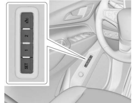
Si está equipado, los asientos de memoria permiten que dos conductores guarden y recuperen sus posiciones de asiento únicas para conducir el vehículo, y una posición compartida de salida para salir del vehículo. También se pueden guardar otras posiciones de función, tales como los espejos eléctricos y el volante de dirección hidráulica, si está equipado. Las posiciones de memoria están enlazadas al transmisor RKE 1 o 2 para recuperaciones de memoria automáticas.
