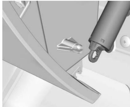
2. Desconecte el deflector de la puerta de la guantera (1) del ensamble de la puerta de la
