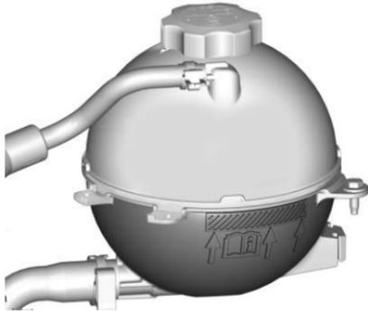
Revise si se alcanza a ver refrigerante en el tanque de compensación del refrigerante. Si el refrigerante que está dentro del tanque de compensación del refrigerante está hirviendo, no haga nada más hasta que se enfríe. Si el refrigerante está visible pero no lo está, agregue una mezcla 50/50 de agua limpia y potable con refrigerante DEX-COOL en el tanque de expansión de refrigerante hasta la nervadura superior en la parte media del tanque, pero asegúrese de que el sistema de
