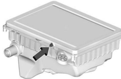
1. Alinee el depurador/filtro de aire con el punto indicado en la base del alojamiento del depurador/filtro de aire e instale el depurador/filtro de aire. El sello del depurador/filtro de aire exterior se debe instalar adecuadamente en el alojamiento del depurador/filtro de aire.
